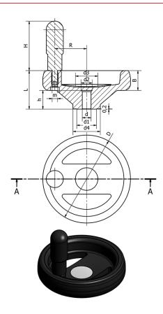
d H7 = 10 = 17 В = 20 Н Code = 79161-R= 37 L = 99 = 37 D R Type = VRTP.100-P+I-SST-10 d1 = 18 Weight (g) = 145d2 = 16 d3 = 20.5
